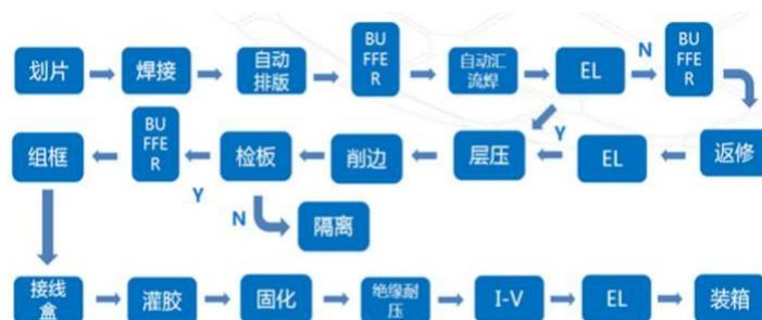
图 5-1 生产工艺流程图
